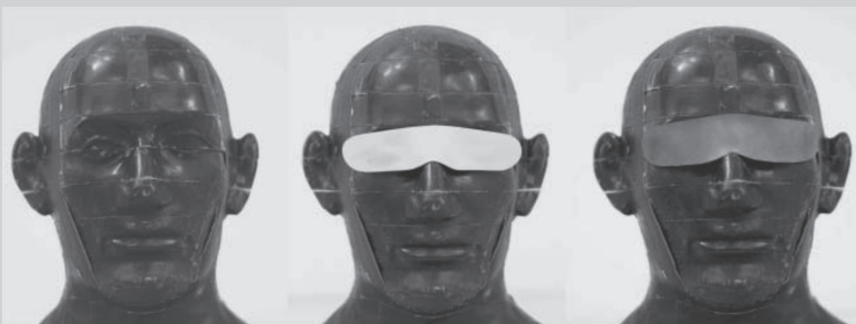
Abb. 3: Aldersonphantom, Schutz der Augenlinse in der Computertomographie – Dosisevaluation an einem antropomorphen Phantom mittels Thermolumineszenzdosimetrie und Monte-Carlo-Simulationen, RÖFo 12-08, 1047-1053
